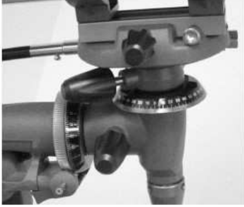
Şekil 2-21 Yıldız açısı (dik açıklık) dairesinin üstündeki yıldız açısı kilit düğmesi ve R.A. dairesinin üstündeki R.A. kilit düğmesi.
